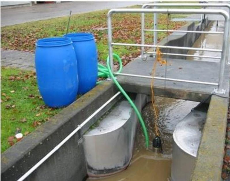
**Abbildung 56: Versuchsanordnung zur Probenahme auf der Kläranlage Holzkirchen (Schwarz, 2007).**
