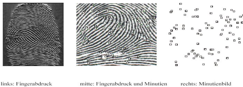
Abbildung 9.3: Generierung eines Tamplets aus einem Fingerabdruck (aus [5], S. 11)
