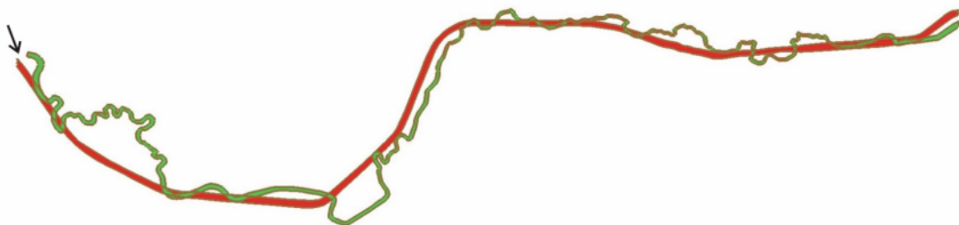
Abbildung 4.28: Laufverlängerung um 32,2 % durch Gewässerrenaturierung am Beispiel des Saubachs
