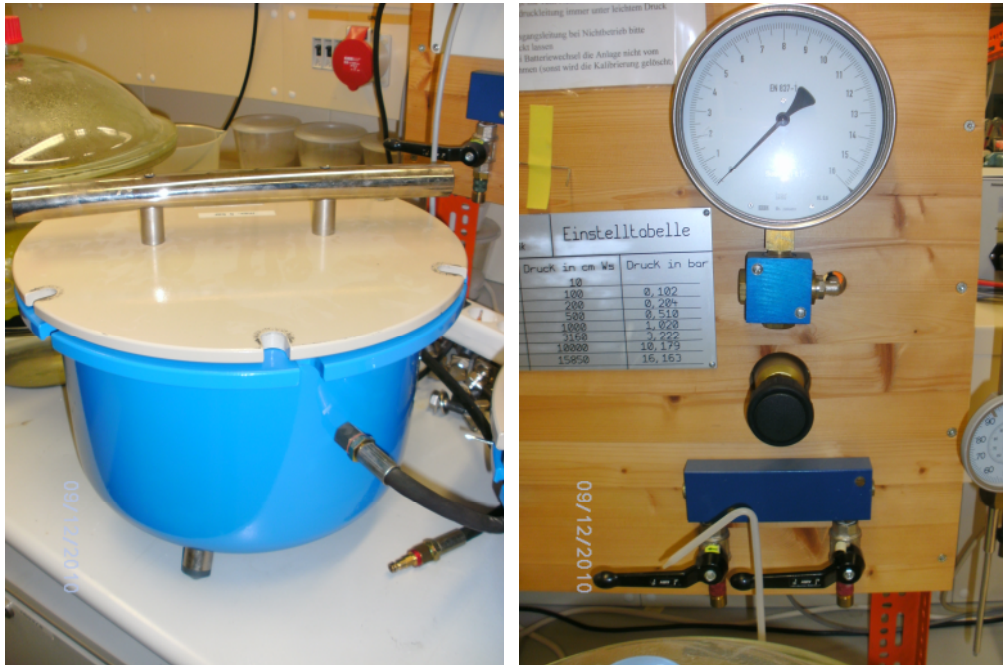
Abbildung 3.25: Versuchsaufbau zur Ermittlung der pF-Kurve im Labor; links: Druckbehälter mit den enthaltenen Bodenproben, rechts: Messuhr mit Druckanschluss
