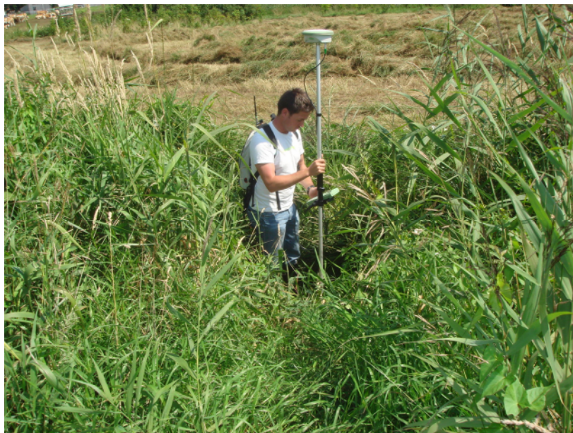
Abbildung 3.31: Vermessung der Windachzuflüsse mittels DGPS
