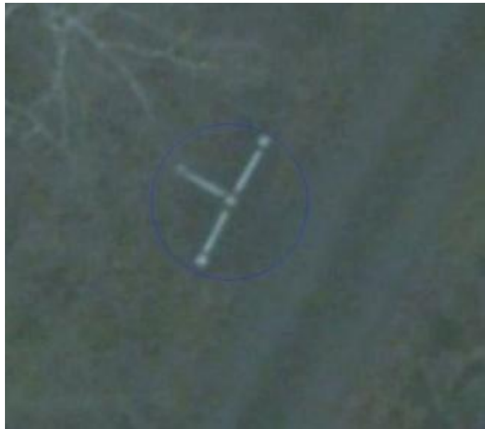
Abb. 5-9: gut ausmessbare PuDig-Messpunkte entlang eines Waldrands (Theisen 2011)
