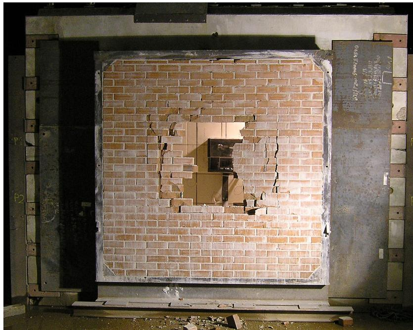
Abbildung 6.9.: Fotografie der zerstörten Mauerwerkswand nach Durchführung des Versuchs [26]
