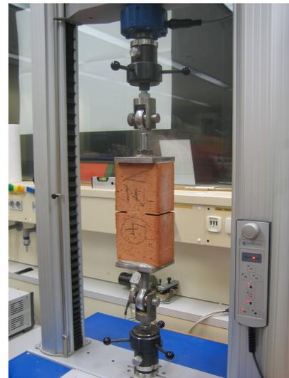
Abbildung 5.10.: Zugversuch an gekerbten Probekörpern
