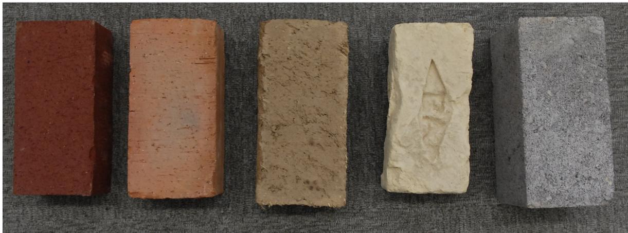
**Abbildung 3.6.:** Untersuchte Ziegeltypen, von links nach rechts: Klinker, normaler Ziegel, deutscher Lehmstein, afghanischer Lehmstein, Betonstein
