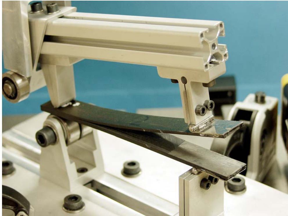
Bild 3.29: Versuchsaufbau mit eingebautem Probekörper nach Durchführung des DCB-Delaminationstests. Die Durchbiegung des nicht vollständig delaminierten Probekörpers zeigt die gespeicherte elastische Energie.
