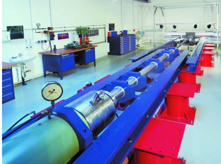
Bild 3.45: Komponentencrashanlage für die Crashversuche mit Motorträgerstrukturen am Ernst-Mach-Institut.
