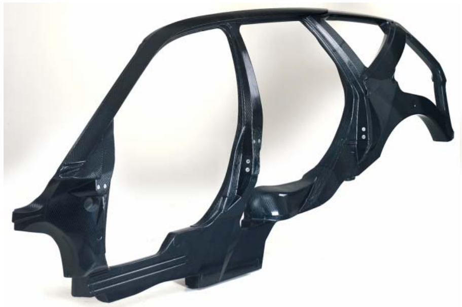
Bild 1.2: Integriertes einteiliges Seitenrahmenbauteil des Technologieträgers BMW Z22 aus CFK mit 50% Gewichtsreduktion gegenüber vergleichbaren Stahlteilen [54].
