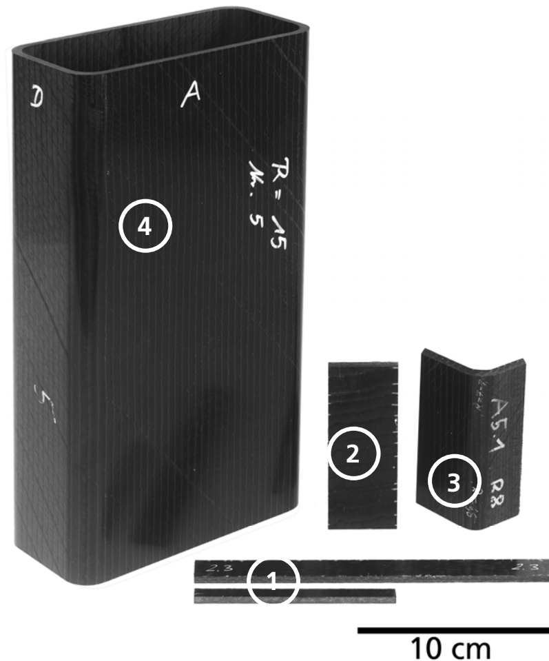
Bild 3.1: Überblick über die in dieser Arbeit verwendeten Probekörper.
