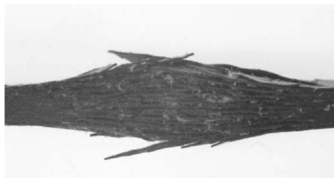
Bild 3.10: Darstellung von in Zugversuchen an [\pm 45^\circ] -Laminaten auftretenden Delaminationen. Diese werden durch die interlaminaren Schubspannungen hervorgerufen, die aufgrund der Umorientierung der Fasern entstehen.
