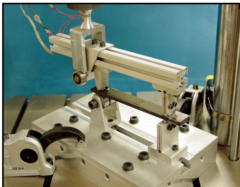
Bild 3.23: Im Rahmen dieser Arbeit neu entwickelter und konstruierter Versuchsaufbau zur Prüfung der unterschiedlichen Delaminationsmodi.
