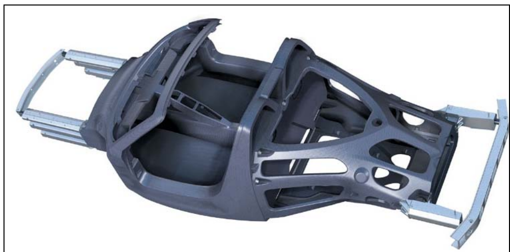
Bild 1.1: Rohkarosserie eines Hochleistungsportwagens mit Fahrgastzelle aus CFK [100].
